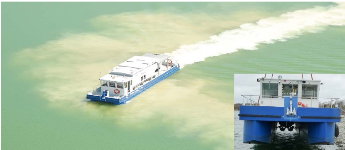
Abb. 11: Gewässerbehandlungsschiff „Barbara“ im Einsatz und beim Einsetzen mit Blick auf das Eintragungssystem zwischen den Bootsrümpfen (rechts unten) (Quelle: LUG/LMBV)
