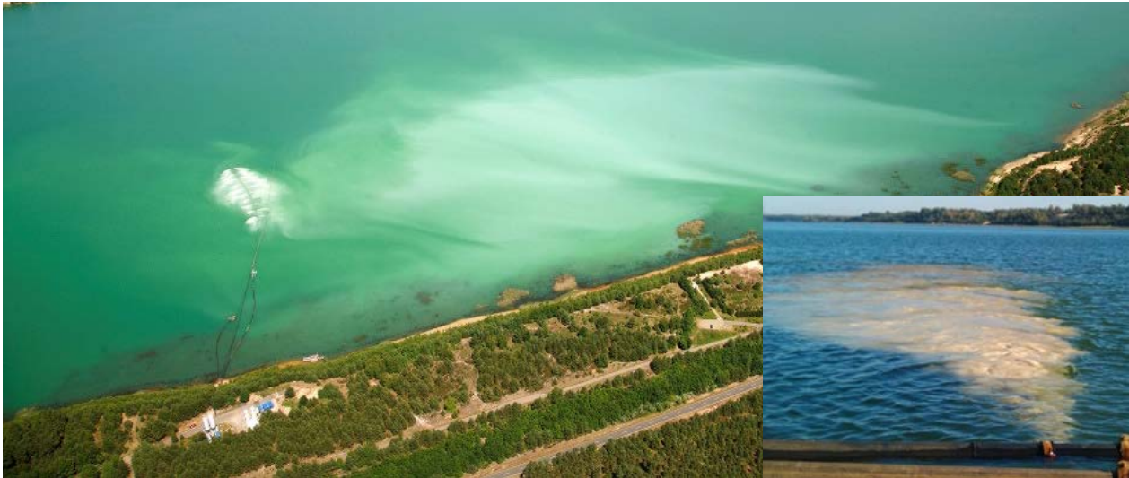
Abb. 16: GSD-Anlage am Scheibe See mit Unterwassereintragssystem (Nahaufnahme) und Verteilung der Kalksuspension im See (Quelle: GMB)
