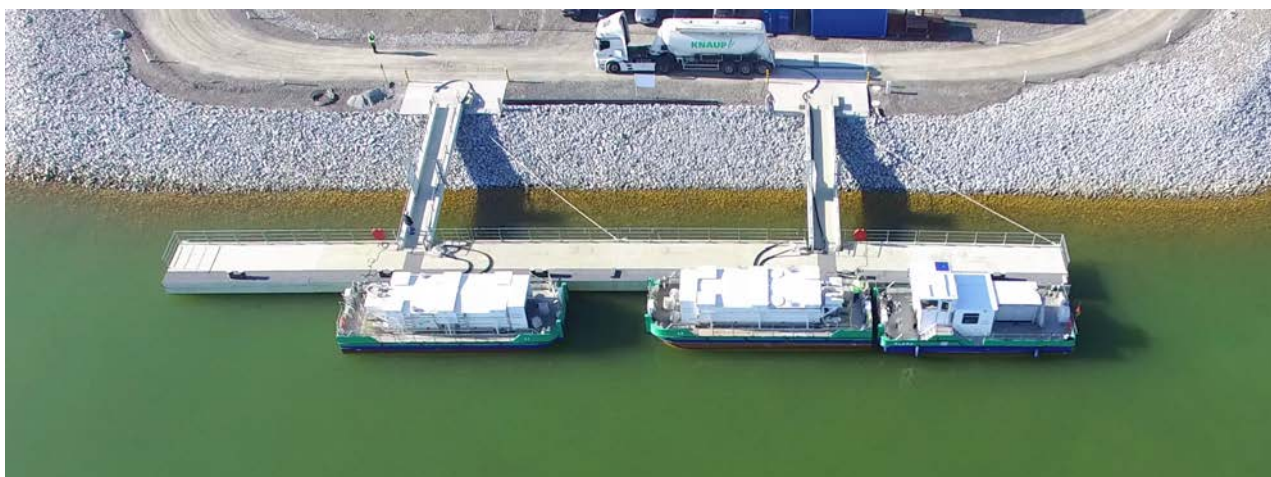
Abb. 14: LMBV-Gewässerbehandlungsschiff „Klara“ gekoppelt mit Leichter 1 (rechts) und Leichter 2 (links) an der Einsatz- und Beladestelle am Ostufer des Koschendamms (Quelle: [33])
