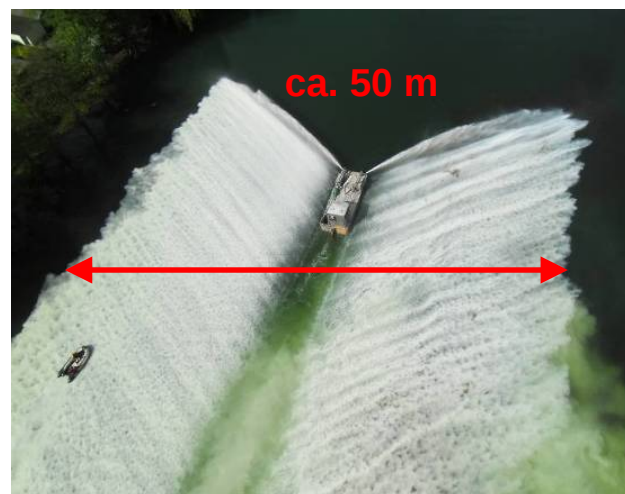
Abb. 7: Links „Brahe II“-Schiff mit Bootsanhänger (Quelle: LMBV) und rechts Versprühung der Kalksuspension (Quelle: [29])
